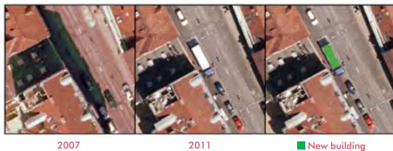
Abbildung 29: Ein Lastwagen, der fälschlicherweise als neues Gebäude klassifiziert wurde
