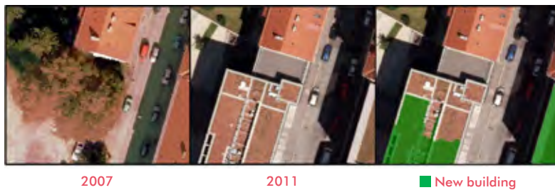
Abbildung 27: Teilweise fehlende Detektion eines neuen Gebäudes aufgrund verschiedener phänologischer Stufen (SALENTINIG, 2012)
