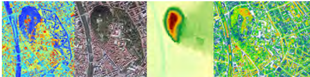
Abbildung 18: Die Datengrundlagen: INTENSITÄTSBILD (LiDAR) – ULTRACAM – DGM – NDSM (von links nach rechts, Quelle: SULZER et al., 2013)
