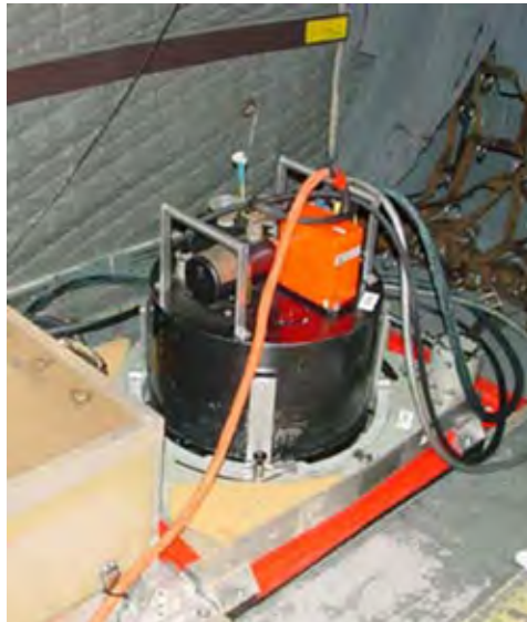
Abbildung 5: Konfiguration des Multispektralscanners DAEDALUS (Quelle: DLR)
